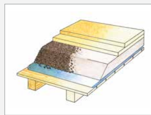
Belastbare Schüttung auf Holzbalkendecke mit Trockenestrichsystem
