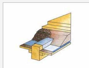
Belastbare Überschüttung der Balkenlage bei verschieden aufgebauten Holzbalkendecken
