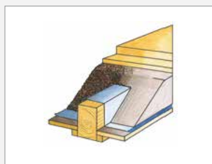
Belastbare Überschüttung der Balkenlage bei verschieden aufgebauten Holzbalkendecken
